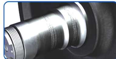
Поперечные задиры шеек или предступичных частей оси.
