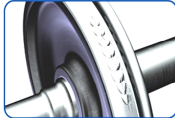
Повреждение поверхности катания колес, вызванное смещением металла («навар»), высотой более 0,5 мм.
