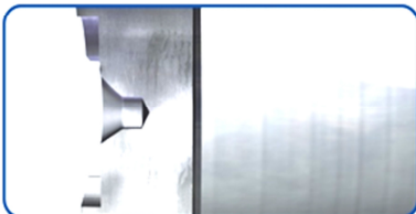
Разработка центрального отверстия.
