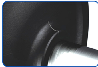
Трещина в ступице колеса.
