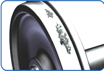
Выщербины, вмятины на поверхности катания бандажа глубиной более 3 мм, длиной более 10 мм; на вершине гребня – длиной более 4 мм.
