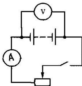
Внутреннее сопротивление источника тока можно измерить косвенным путем, сняв показания амперметра и вольтметра при замкнутом ключе. Действительно, из закона Ома для замкнутой цепи (см. § 108) получаем  $E = U + Ir$ , где  $U = IR$  - напряжение на внешней цепи ( $R$  - сопротивление реостата). Поэтому  $r_{пр} = (E_{пр} - U_{пр})/I_{пр}$ .
