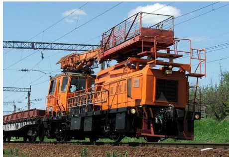
Рис. 69 Автодрезина ДГКУ с оборудованием для подвески контактной сети
