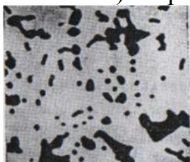
Рисунок 10.3 Литая оловянная бронза с 10% Sn а) микроструктура б) схема микроструктуры
