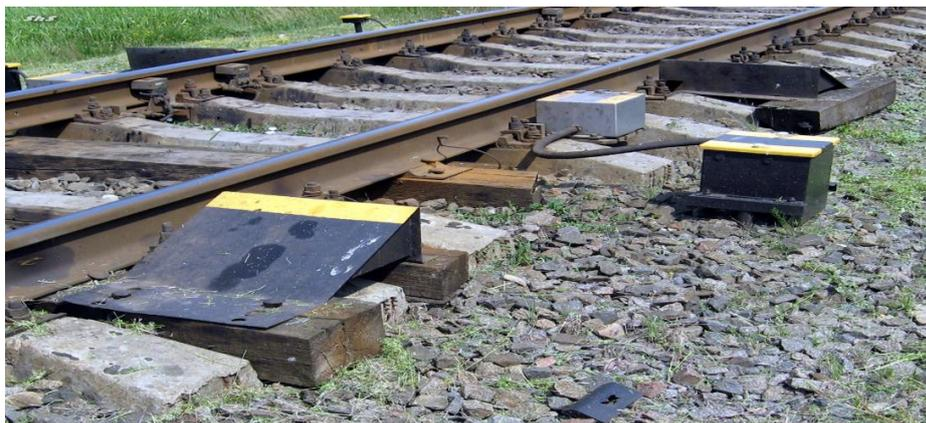
Рисунок 1 датчики системы ПОНАБ для обнаружения греющихся букс.
