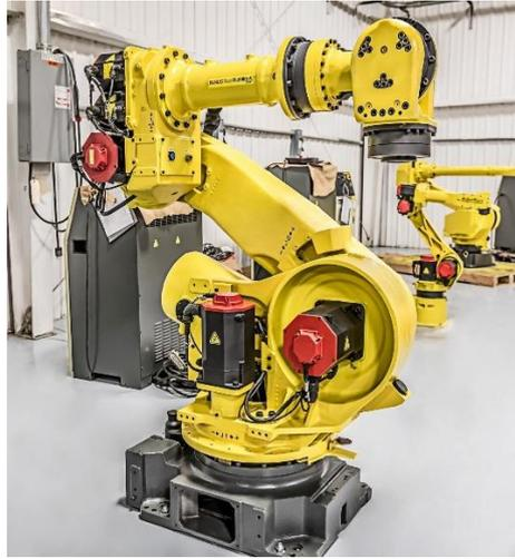
Рисунок 2 робот манипулятор модели Фанук 2000.
